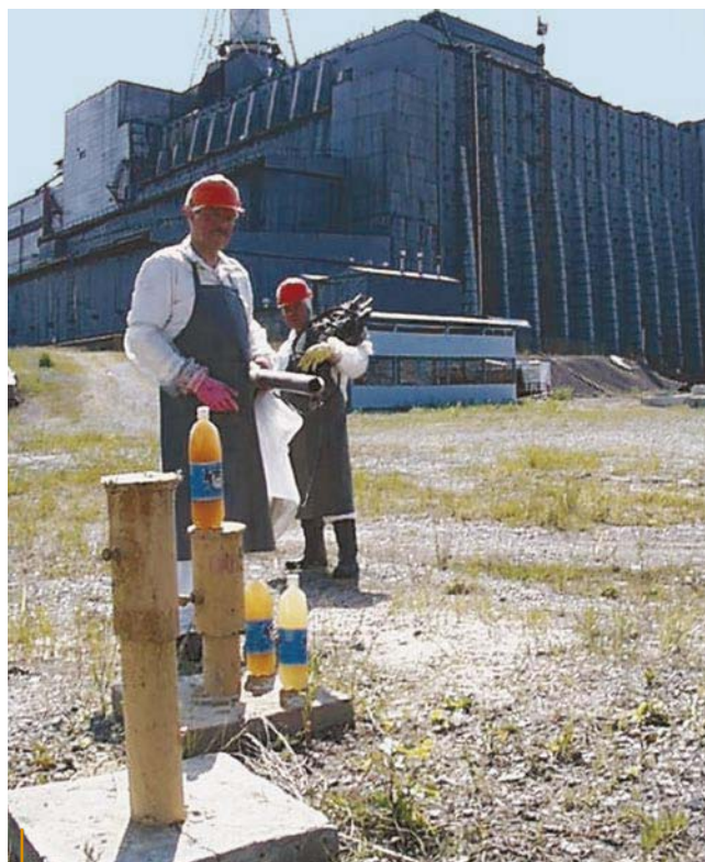
Beprobung der Grundwassermessstellen auf dem Standortgelände des Sarkophags
